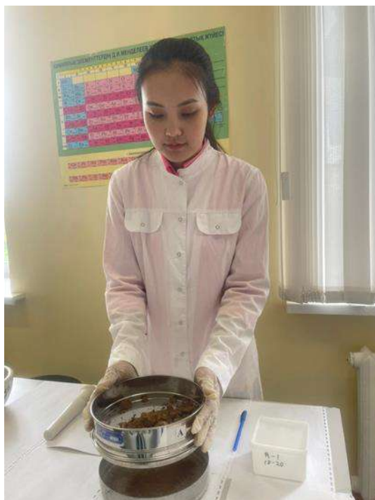
Сурет 4 – Құрғақтай елеу арқылы топырақ құрылымын анықтау
