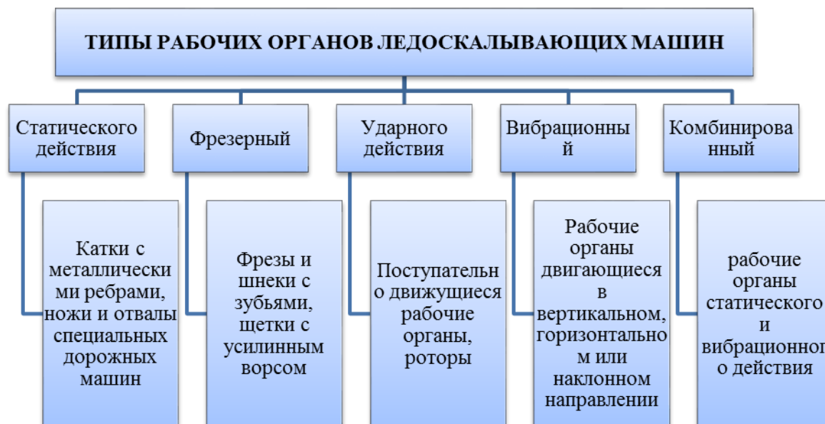
Рисунок 2 – Классификация рабочих органов ледоскалывающих машин
