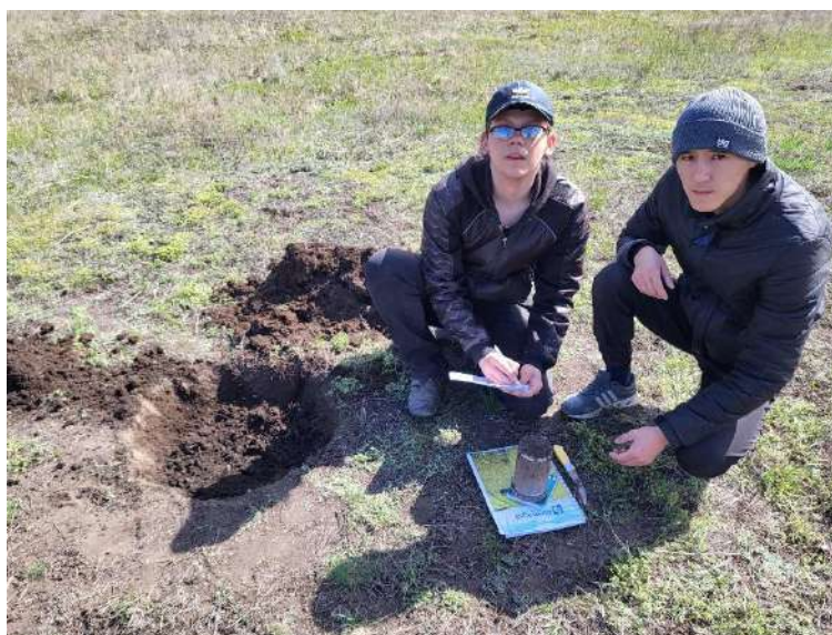
Рисунок 3 – Определение плотности почвы в условиях пастбищ
