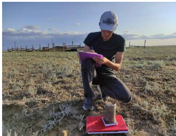
Сурет 3 – Дала жағдайларында жайылымдардың топырақ тығыздығын анықтау
