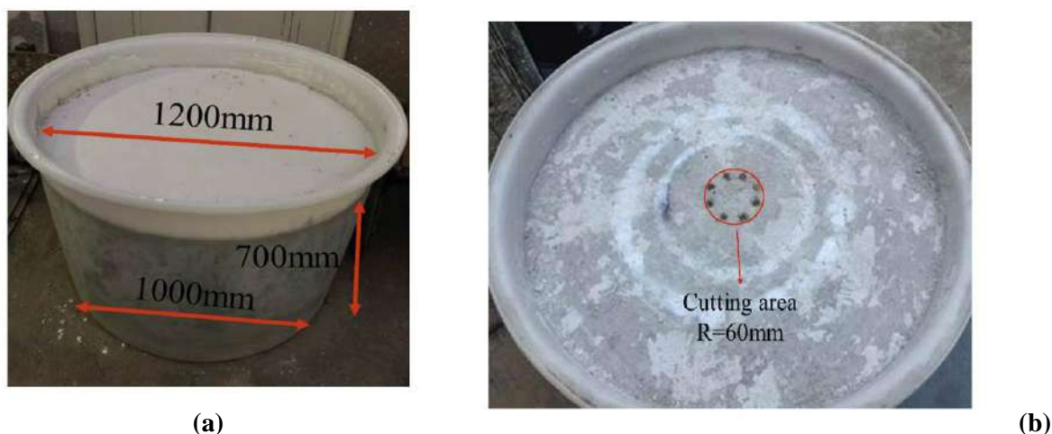
Рисунок 9 – Параметры образцов и площадь резания
