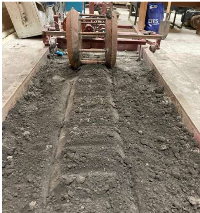
Рисунок 6 – Вид поверхности почвы после прохода усовершенствованного катка
