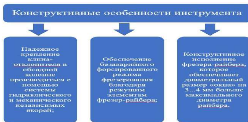
Рисунок 6 – Конструктивные особенности инструмента
