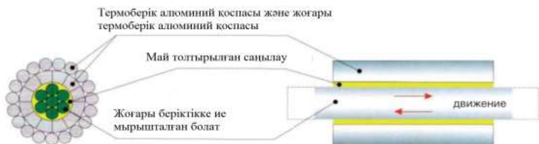
Сурет 4 - ACCR маркалы сымның металлкомпозитті өзекшесінің құрылымы
