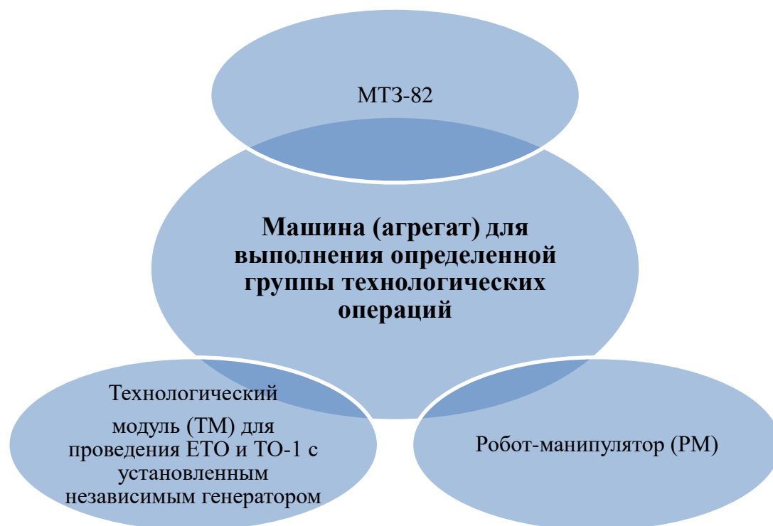
Рисунок 1 - Блочно-модульный принцип формирования агрегата для сервисного обслуживания в полевых условиях.
