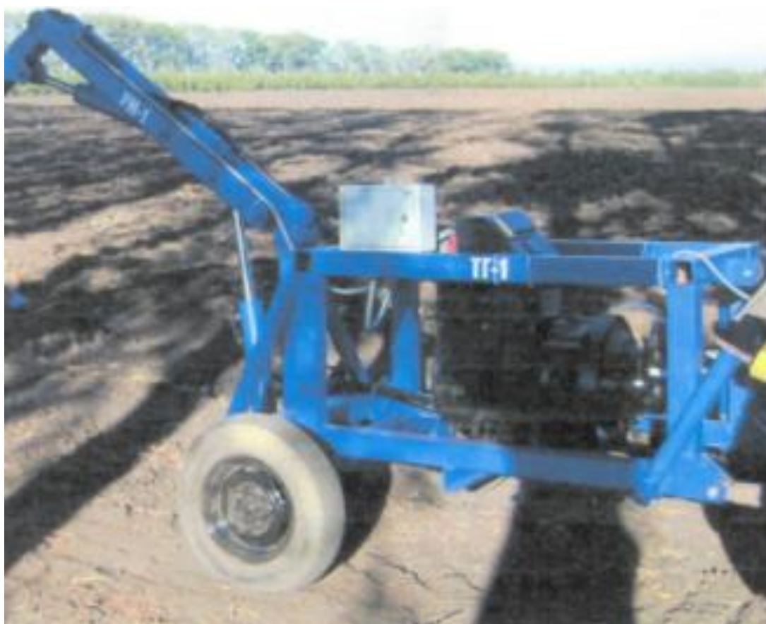
Рисунок 3 – Экспериментальный образец агрегата для технического обслуживания без шкафов для хранения инструмента.
