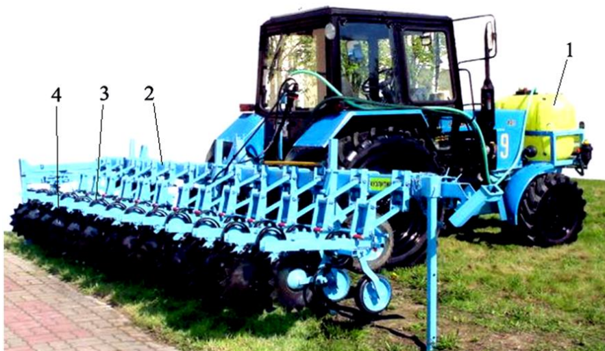
Сурет -3. КЛГ-5,4 гербицидтерді енгізуге арналған қондырғысы бар қызылша қатараралық өңдеуге арналған культиватор. 1-бак; 2-балка; 3 – бүріккіштері бар жұмыс секциялары; 4-дискілер.
