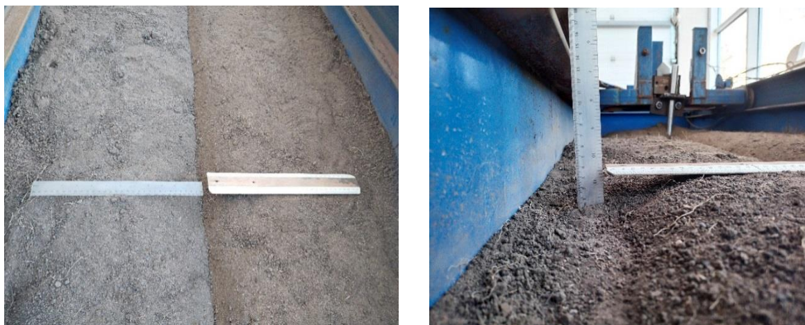
Сурет 3 – Пышақтар жұбымен 0,23–0,25 м тереңдікте жыртып өткенде топырақтың қопсып көтерілу дәрежесі
