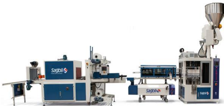
Сурет 2 – Арнайы сұрыпты 5 кг ұнды автоматты түрде өлшеп – орауға арналған «Sagbil» машинасы
