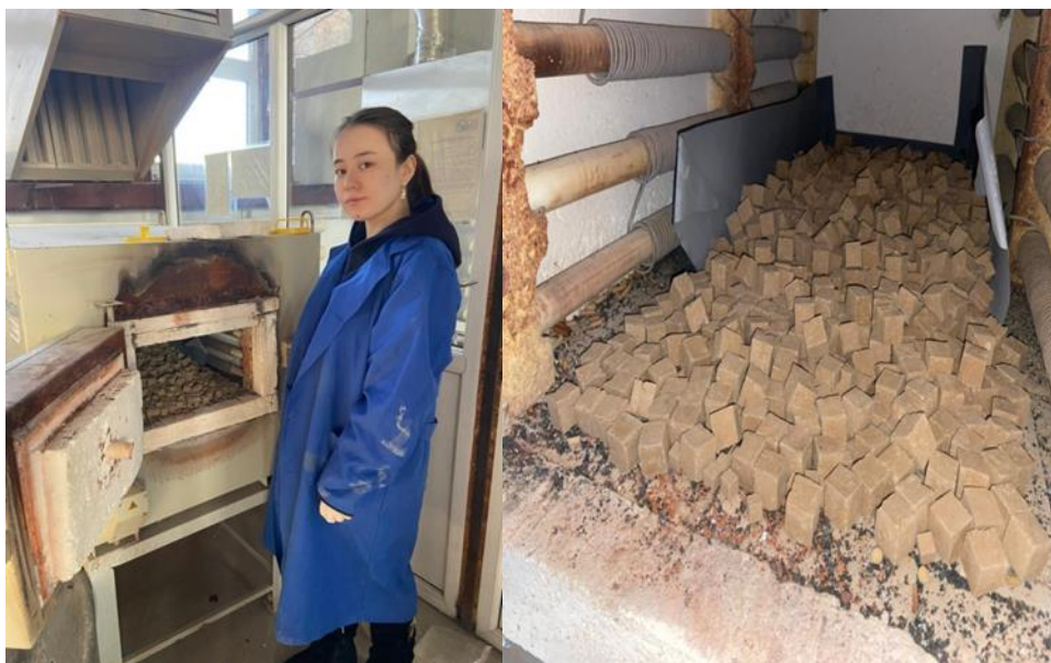
Сурет 3 – Текше пішінді түйіршіктерді электр пешінде күйдіруге дайындық сәті.
