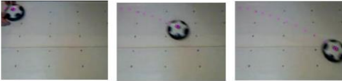
Сурет 3 – Көлбеуленген үстел бойымен бастапқы жылдамдықпен үйкеліссіз ойыншықтың қозғалысы
