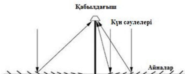
Сурет 2 – Френель айналары бар жалпақ айна шағылыстырғышы
