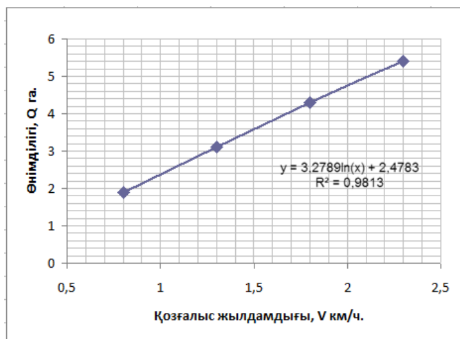
Сурет 2 – Қопсытқыш-тиегіш өнімділігінің қозғалыс жылдамдығына тәуелділігі
