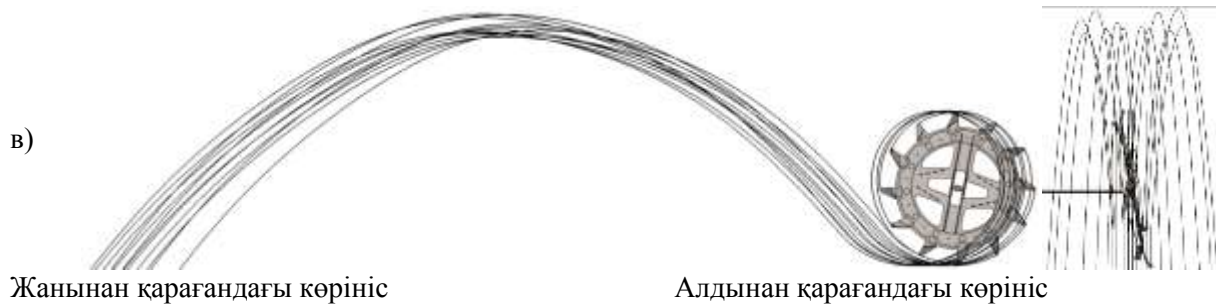
Сурет 1 - YOX және YOZ жазықтығындағы топырақ бөлшектерінің ұшу траекториясының проекциясы: а) фрезаның орнату бұрышы 90 градус; б) фрезаның орнату бұрышы 85 градус; в) фрезаның орнату бұрышы 80 градус.
