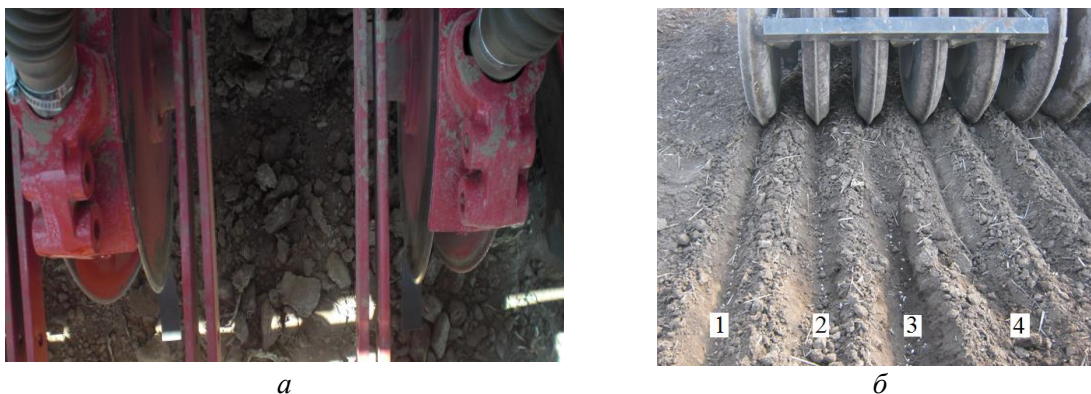
4 сурет – Фигурлы пластинамен жабдықталған СЗП-3,6 сепкішін сіңіргіштері және тұқымдардың қарық қатарларында таратылуы
