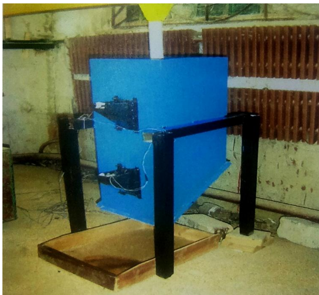
Рисунок 4 – Общий вид экспериментальной установки для исследований датчиков уровня корма в самокормушке
