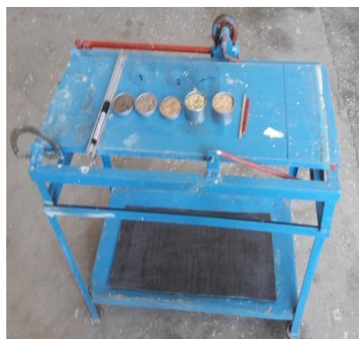
Рисунок 1 – Общий вид лабораторной установки «Наклонная плоскость»
