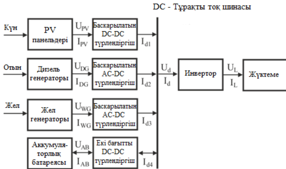
Сурет 2 – Тұрақты ток шинасы арқылы энергия ағындарын жинақтайтын гибриді электрмен жабдықтау жүйелері
