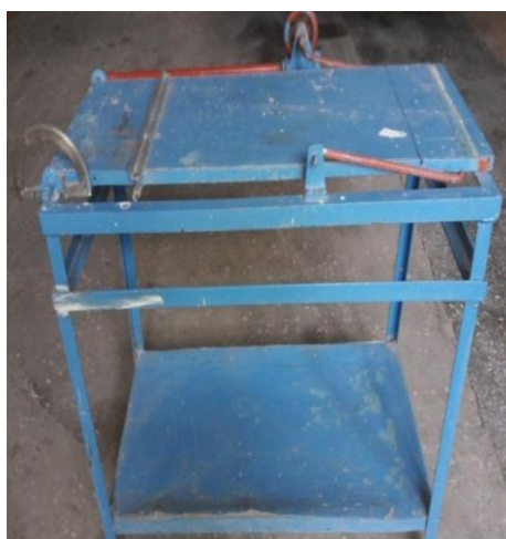
Рисунок 1 – Общий вид лабораторной установки «Наклонная плоскость»
