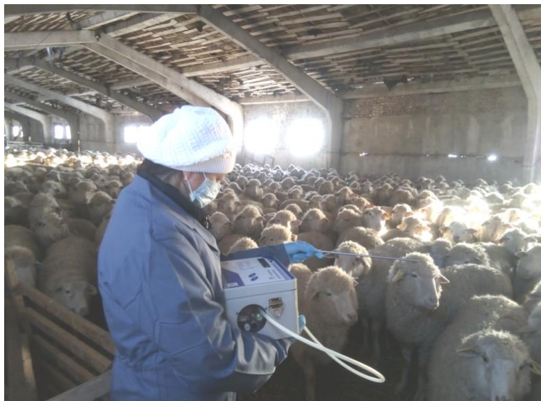
Рисунок 1 – Измерение газового состава газоанализатором ГАНК-4 КПКУ 413322 002
