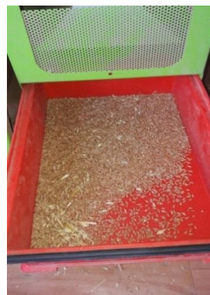
Сурет 5 – «WINTERSTEIGER» бастырғыш қондырғысы: a – жалпы – түрі; б – бастырылған дәндер
