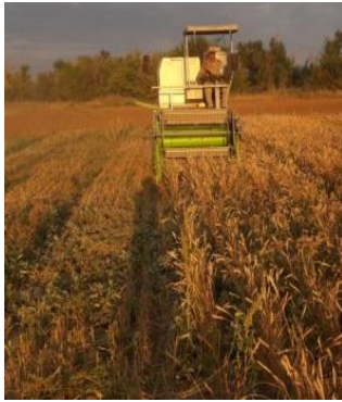
Сурет 4 – Есептік алаңнан егінді орауға арналған «WINTERSTEIGER» шағын габаритті селекциялық комбайнынмен егінді орау
