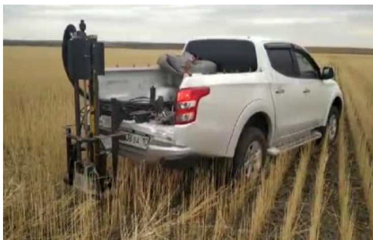
Рисунок 1 – Отбор почвенных образцов автоматическим пробоотборником
