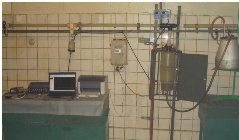
Рисунок 1 – Общий вид экспериментальной установки для исследования расходных характеристик счетчика-эвакуатора молока
