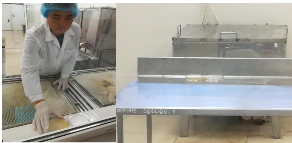
Рисунок 2 – Размещение чашек Петри с МПА для седиментационного метода
