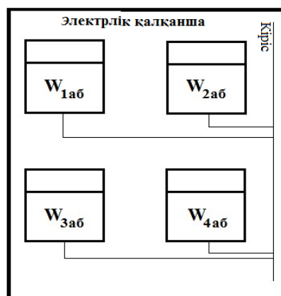
Сурет 1 – Көп пәтерлі тұрғын үйдегі электр энергиясын есепке алудың ықшамдалған схемасы
