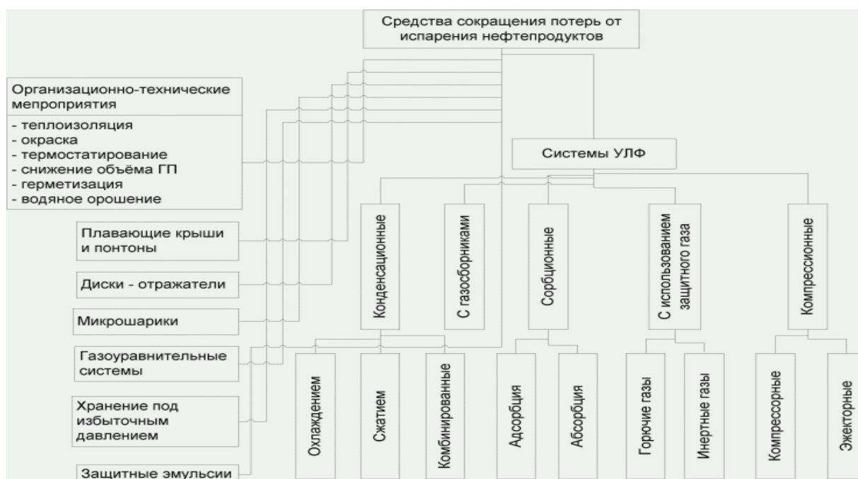
Рисунок 2 – Средства сокращения потерь от испарения (УЛФ - улавливание лёгких фракций)
