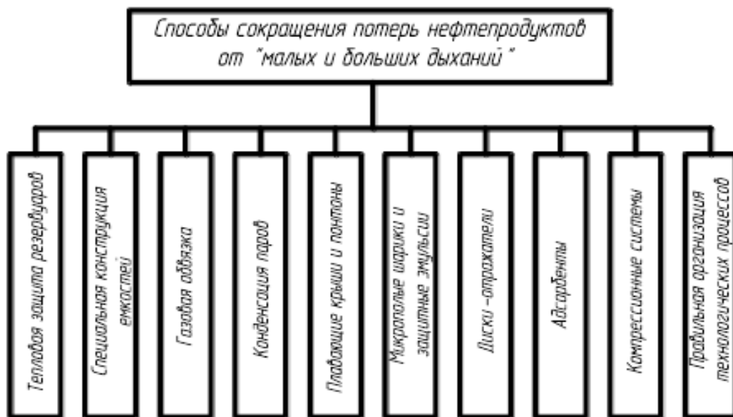
Рисунок 1 – Способы сокращения потерь нефтепродуктов от испарения
