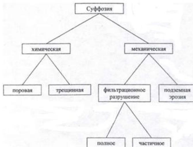
Рисунок 1 – Схема деления суффозий
