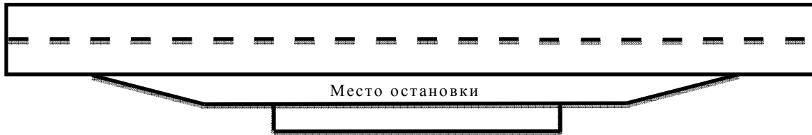
Рисунок 1 – Геометрическое формирование ОП «заездной карман»
