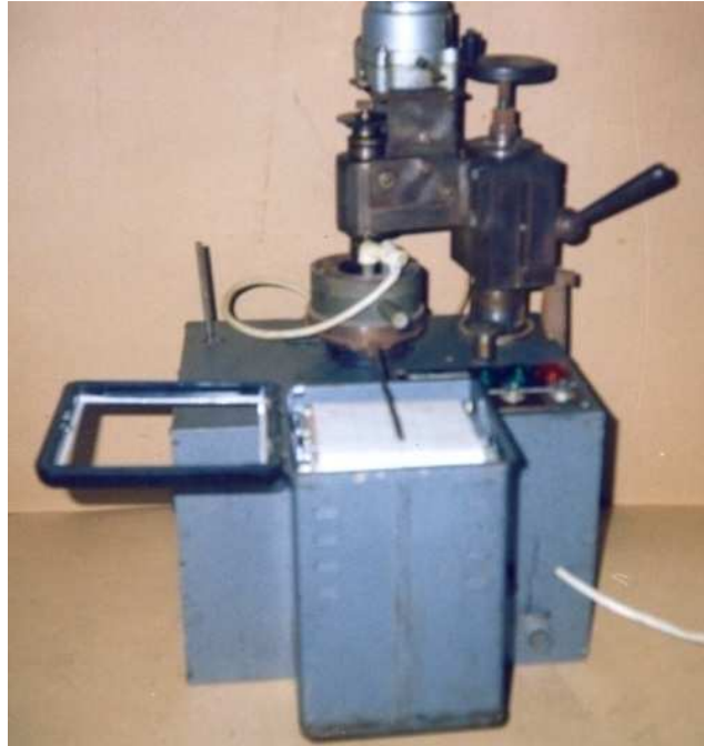
Рисунок 2 – Четырехшариковая машина трения КТ–2
