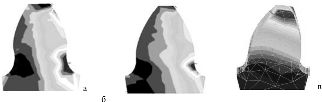
Рисунок 4 – Распределение напряжений в зубе
