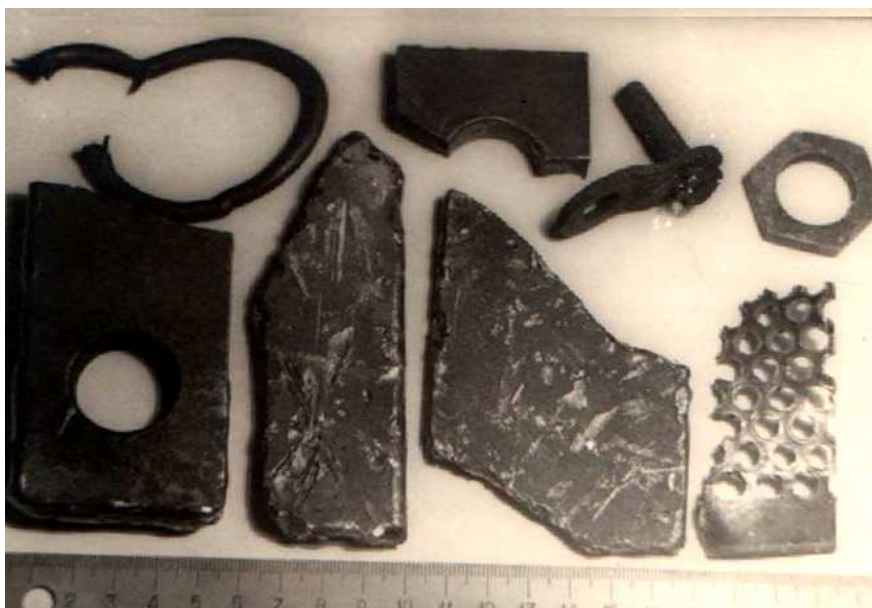
Рисунок 1 – Твердые предметы, извлеченные из стебельных кормов
