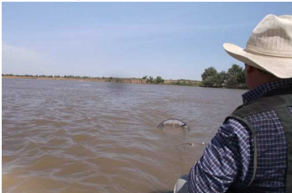
Рисунок 1 – Отбор проб покатной молоди ихтиопланктонной ловушкой на течении с заякоренной лодки, май 2016 г.
