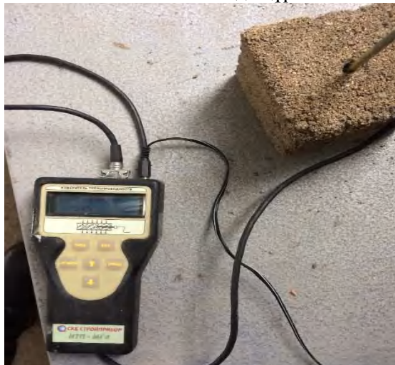
2 сурет – ИТП - МГ4 «Зонд» құралымен жылу өткізгіштікті анықтау барысы
