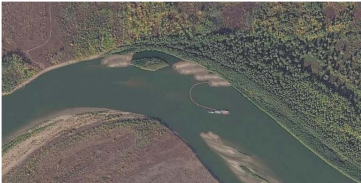
Рисунок 3 – Работа дноуглубительного земснаряда с отвалом грунтов в русле реки, напротив нерестилища В. Малотеевское
