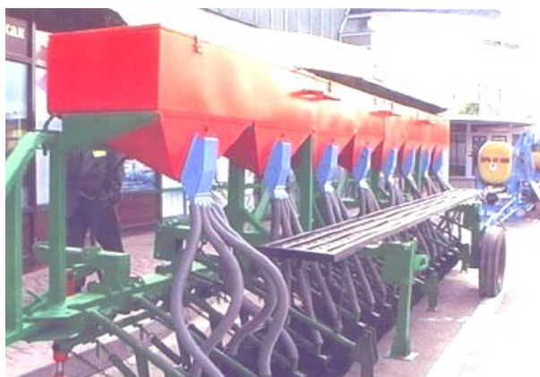
Рисунок 1 – Сеялка Клен с системой дифференцированного высева семян и удобрений
