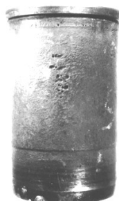
Рисунок 2 – Кавитационные разрушения стенки гильзы двигатель КамАЗ-740
