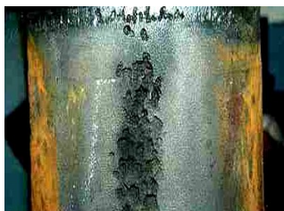
Рисунок 3 – Слияние кавитационных раковин в одну сплошную зону
