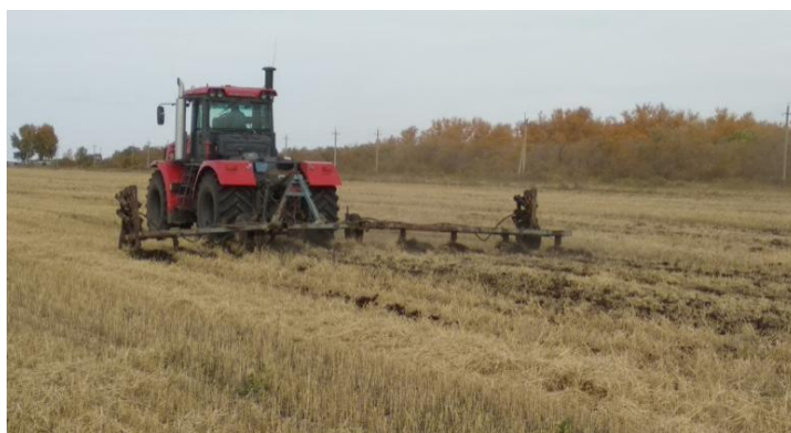
Рисунок 1 – Почвообрабатывающее орудие КПШ-11 в агрегате с трактором К-744Р2, оборудованного системой автоматического вождения. Вид в работе
