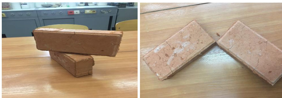
Сурет 5. Шикізат құрамына негізделген керамикалық жабын тастарының үлгілері саз - тальк жынысы
