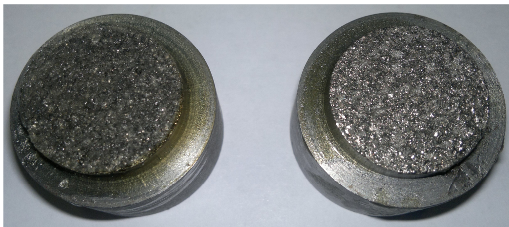
Рисунок 4 – Образцы, прошедшие испытание на прочность сцепления
