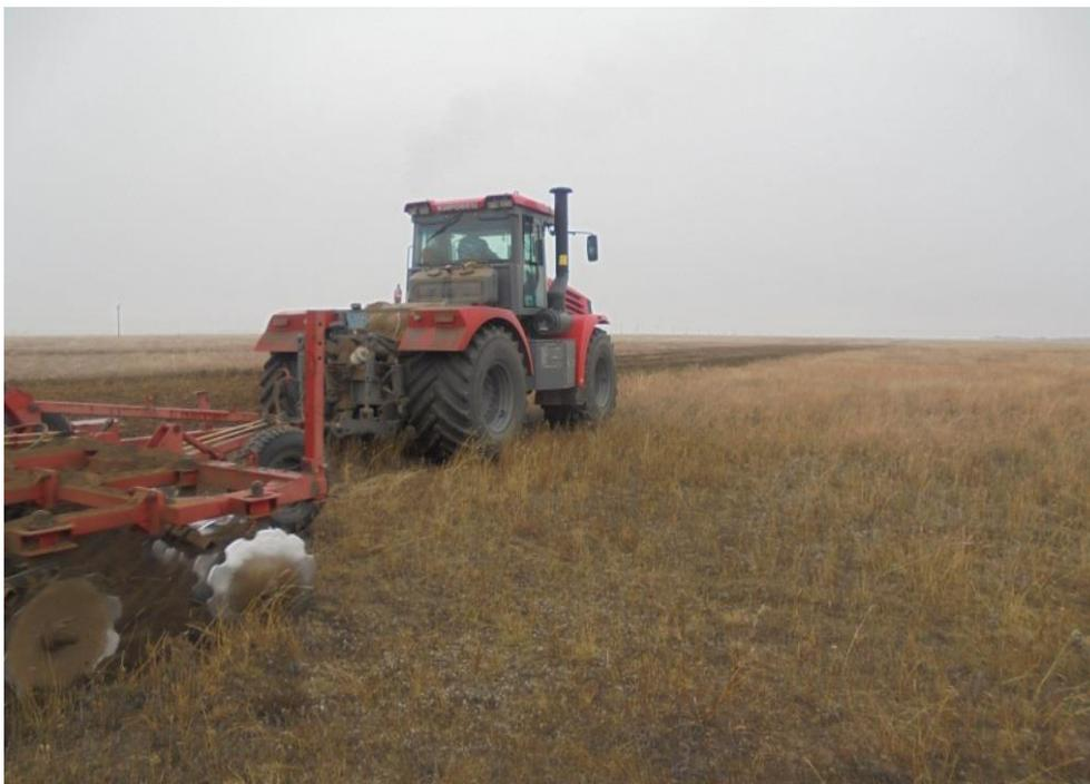
Рисунок 1. Проведение обработки дернины пастбища БДТ-6 в КХ «Баян»
