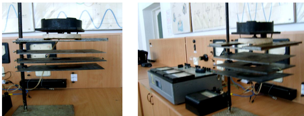
Рисунок 2 – Лабораторная установка по определению коэффициента чувствительности глин к сушке по экспресс-методу А. Ф. Чижского
