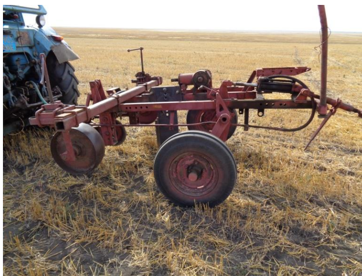
Рисунок 1 – Лабораторно-полевая установка для определения тягового сопротивления щелереза
