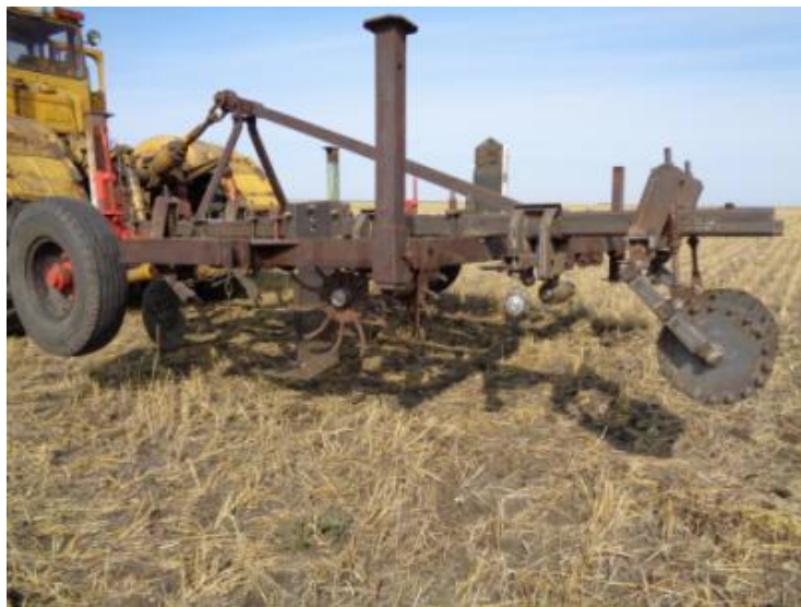
Рисунок 2 – Лабораторно-полевая установка для определения тягового сопротивления конструктивно-технологических схем щелевателя
