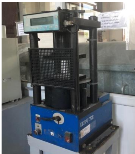
3 сурет - ПГМ-500 МГ4 гидравликалық сынақ прессі
