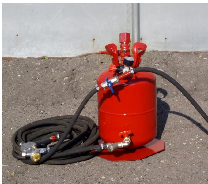
Рисунок 2 - Переносной консервационный распылитель ПРК-1-2
