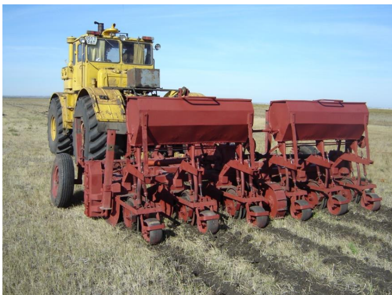
Рисунок 1 – ОПП-6 для полосного подсева трав в агрегате с трактором К-701, вид в работе
