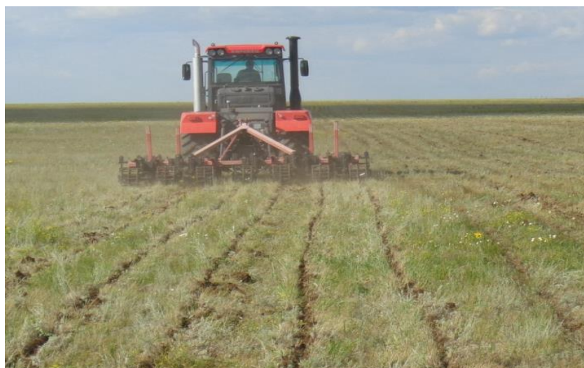
Рисунок 2 – Щелеватель ЩН-7 в агрегате с трактором К-744Р2, вид в работе
