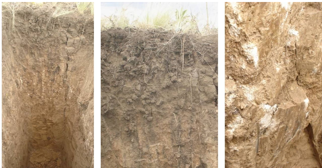
Слева – общий вид разреза; в центре – горизонты А (0-25см), В 1 (25-45 см) скопление солей в горизонте Вк (45-86 см).
